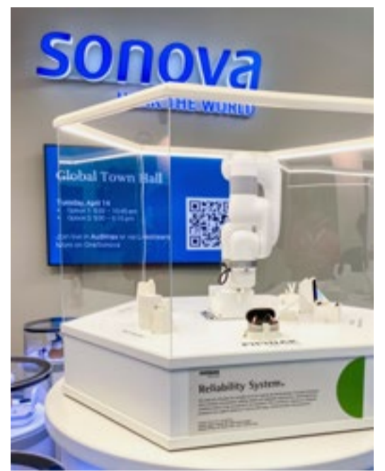
Automatisiertes Reliability-Testsystem für Hörgeräte bei der Sonova AG.
